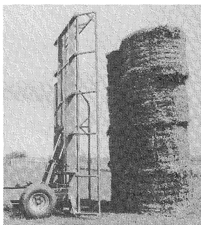
Rundballen werden in Form von Ballensäulen abgestellt. Bei der Abholung werden die Greiferzähne lediglich unter die gewünschten Ballensäulen gefahren.
