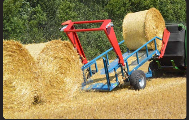
Greifen mit doppelwirkenden hydraulischen Zylindern. Angestattet mit Beleuchtung (Blinker) und Reflektoren.
