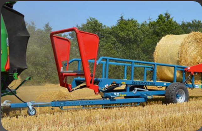
Starker Ladebügel mit der option variabel auf Ballen-größe einstellbar.
