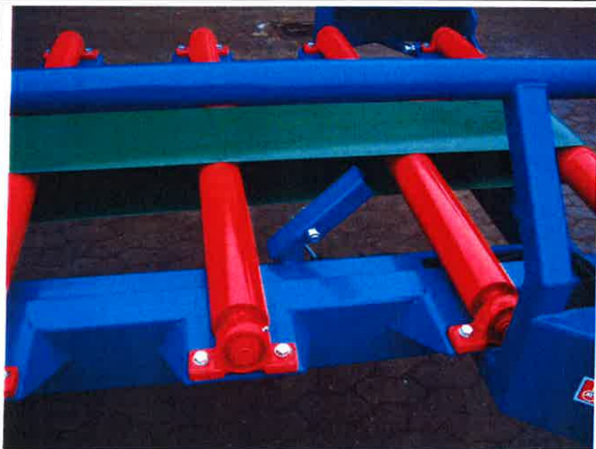
Ballekontakten er std. Udstyr på alle typer. Båndrullerne er lejrede i forseglede lejer med smørbare lejhuse. QB-3 Vognen leveres med manuelt sideforskydelig befæstigelse for hjulsystemets styrecylinder. Denne skal sideforskydes ved landevejstransport.
