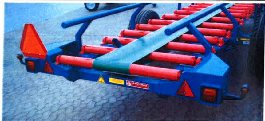
Ballekontakten er std. Udstyr på alle typer. Båndrullerne er lejrede i forseglede lejer med smørbare lejhuse. QB-3 Vognen leveres med manuelt sideforskydelig befæstigelse for hjulsystemets styrecylinder. Denne skal sideforskydes ved landevejstransport.
