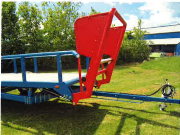
Robust læsserampe med mulighed for montering af ekstra tværbøjle til justering af ballestørrelse.
