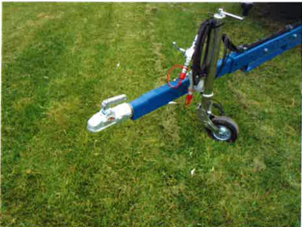
Kraftigt kugletræk til nem på- og afmontering. Sikrer stabil og rolig gang af vognen under arbejde og transport.
