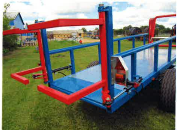
Solid aflæsserport med dobbeltvirkende cylindere. Udstyret med lovpligtigt lys- og markeringsanlæg samt refleks.
