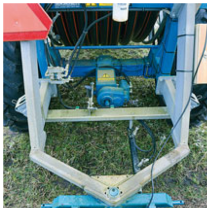
An der Hinterachse ist ein Hydraulikmotor angeflanscht, der die Maschine antreibt.
