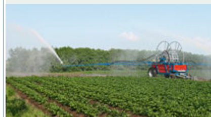
Die FM 4900 regnet über einen Auslegearm und zwei Mittelstarkregner.
